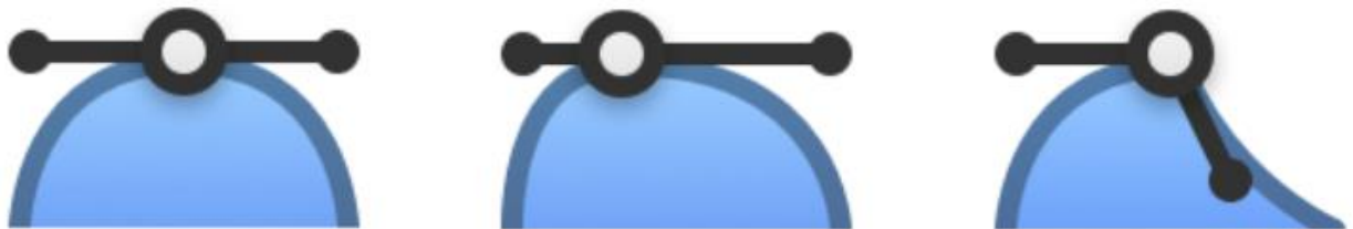
Рисунок 2.4 – Візуальне представлення дзеркального, асиметричного та розімкнутого способів управління
